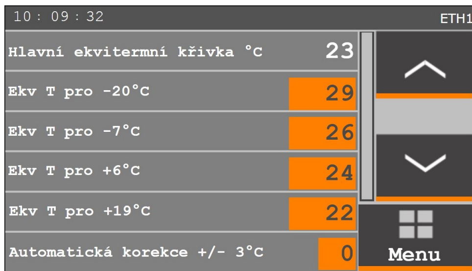
Obrázek 4.13: Sekce Objekt - obrazovka 2 → Hlav. ekv. křiv. °C
