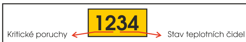
Obrázek 7.1: Dělení poruch a stavů tepelného čerpadla
