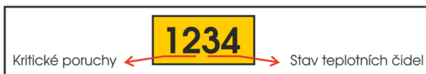
Obrázek 7.1: Dělení poruch a stavů tepelného čerpadla
